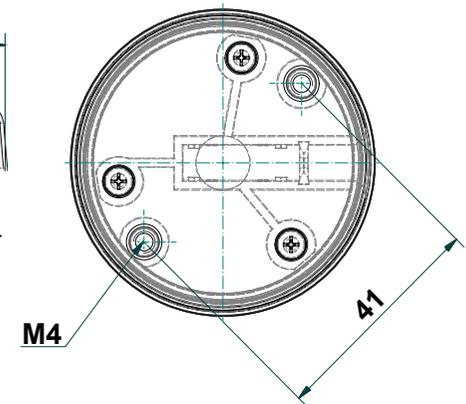
Mit 2 St. Einpressmuttern für Schrauben M4. Max. Einschraubtiefe 5mm.
